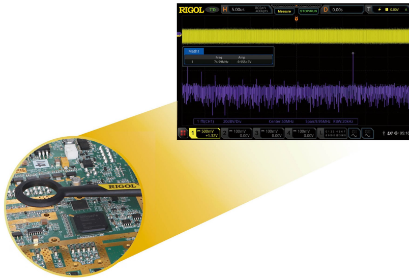
Figura 2.7: Con la sonda de campo cercano, puede observar fácilmente el pico del espectro en el dominio de frecuencia cuando la sonda se acerca al punto de fuga de radiación.
