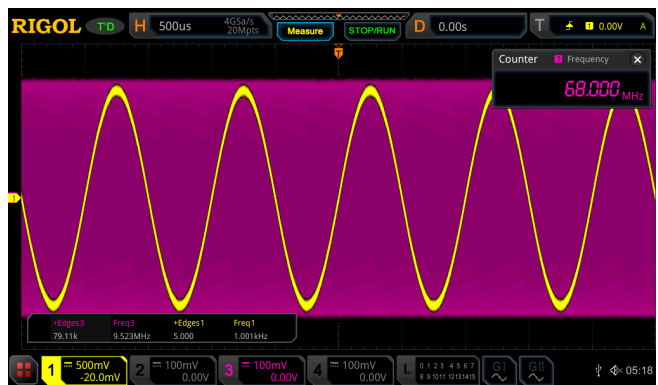
Figura 2.5: La medición normal de software de 1 Mpts ya no puede medir la frecuencia exacta de la señal de alta frecuencia.
