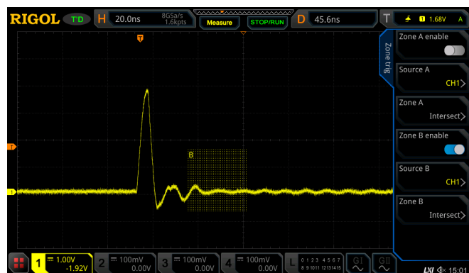
Figura 2.9: Aísle rápidamente la señal excepcional con el disparador Edge y el disparador de zona.
